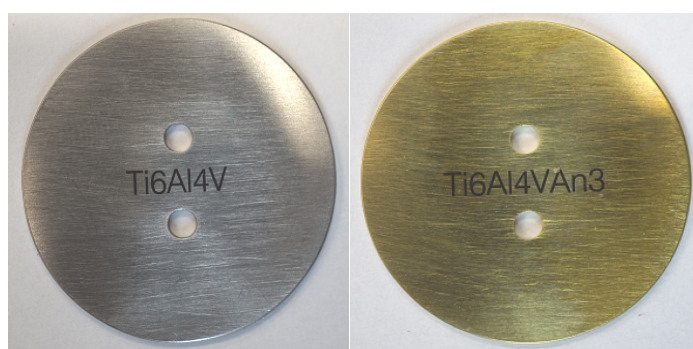
Rycina 15. Krążki: po lewej „surowy” bez powłoki, po prawej z powłoką anodową III typu.
